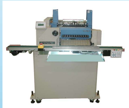
世界初の自動端子からげ 機能付きインデックス 自動巻線機AW861を発売
