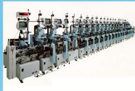
フリーフローコンベア 搬送タイプのコイル 自動生産ライン発売
