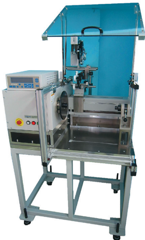
AX2 SPS500仕様 (オプション) 最大ボビン外径φ500mm対応
